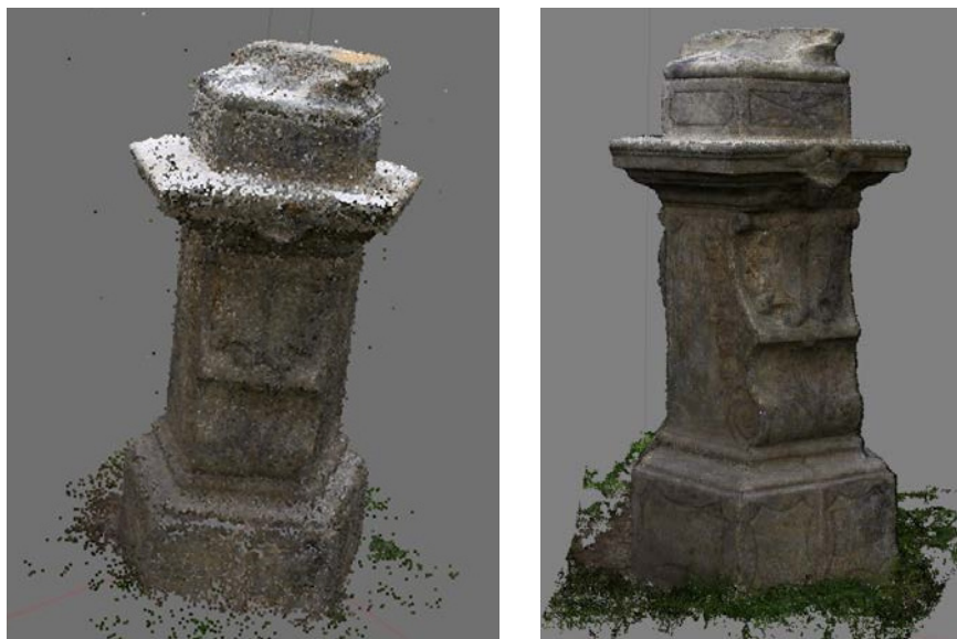
Obr. 33a, b. Vytvořené řídké bodové mračno (vlevo), vytvořené mračno bodů s vysokým rozlišením (vpravo).
