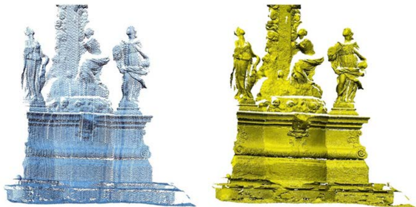
Obr. 9. Ukázka dat: mračno bodů (vlevo), polygonová síť (vpravo).
