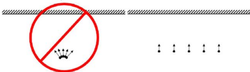
Obr. 28. Chybná a správná pozice fotoaparátu při zaměřování průčelí budovy.
